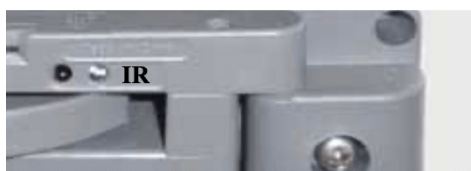
IR = Infra-vermelhos. Indicador de abertura de só uma gaveta numa só linha.
