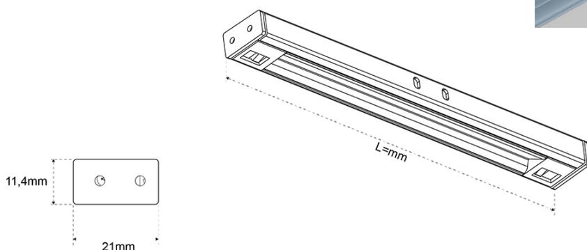
Para espessura de placa: 15, 16, 18, 19 mm
